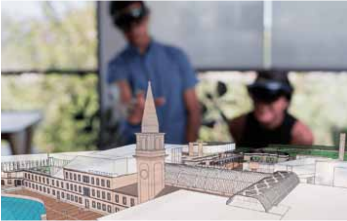
Die Mixed-Reality-Software Trimble-„SketchUp Viewer“ ermöglicht es, 3D-Modelle beispielsweise von Trimble-„SketchUp“ und Tekla-„Structures“ holographisch auf die reale Welt zu projizieren.
