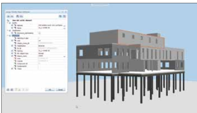
Gängige Praxis in der BIM-basierten Planung ist die Arbeit mit Fachmodellen, etwa für Architektur, Haustechnik und Tragwerksplanung – hier die Beispiele eines Architektur- und Tragwerksmodells.
